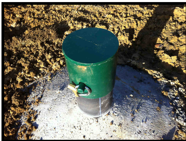
Figure 8 : Bouche du piézomètre Pz 2
