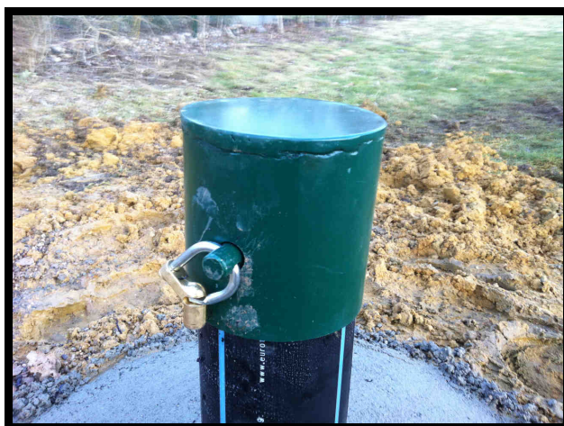
Figure 9 : Bouche du piézomètre Pz 3
