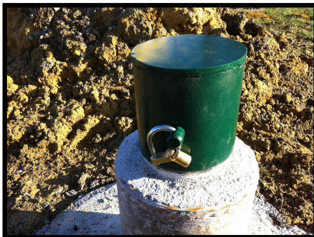
Figure 7 : Bouche du piézomètre Pz 1
