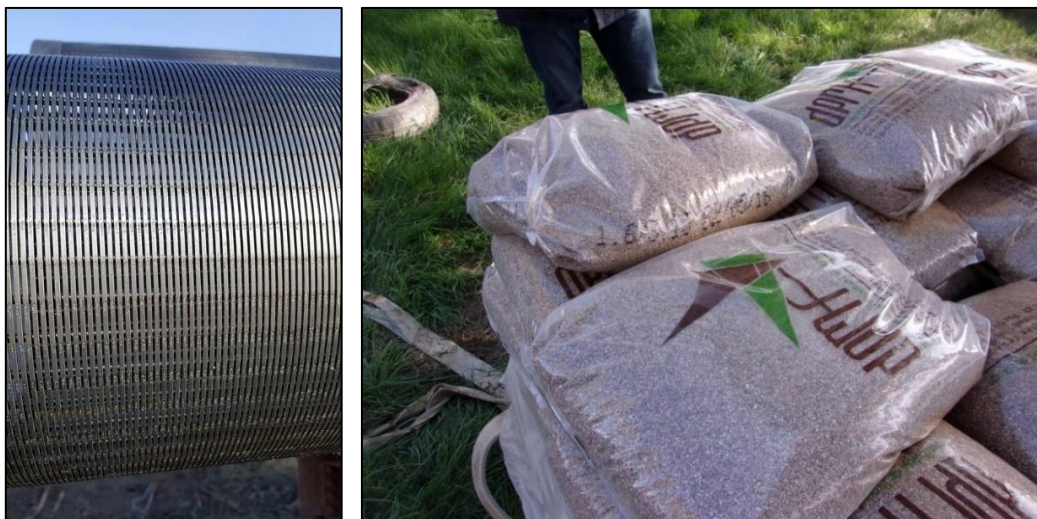
Figure 6 : Crépine en fil enroulé et gravier utilisé pour le massif filtrant
