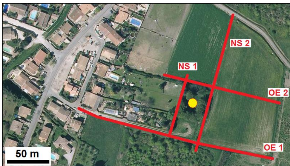
Figure 3 : Panneaux électriques réalisés sur le site des Canabières à MANDUEL
