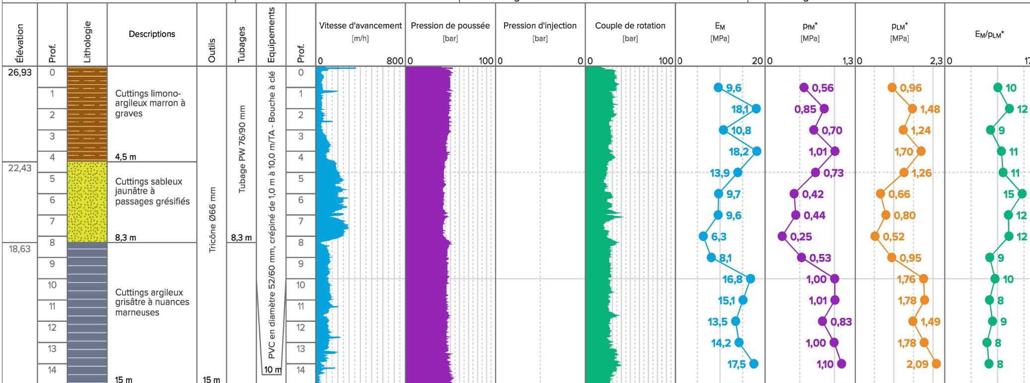
**Commentaires** Méthodologie de forage avec injection d'eau ne permettant pas de définir un niveau d'eau stable. Niveau d'eau mesuré ponctuellement à 7,00 m/TA en fin de sondage.
