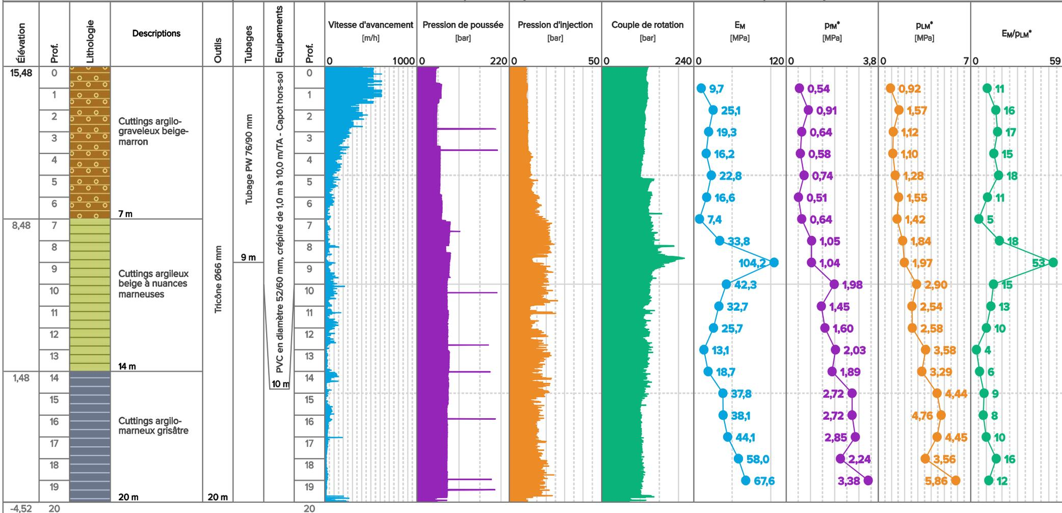
**Commentaires** Méthodologie de forage avec injection d'eau ne permettant pas de définir un niveau d'eau stable. Aucun niveau d'eau mesuré ponctuellement au sein du sondage.
