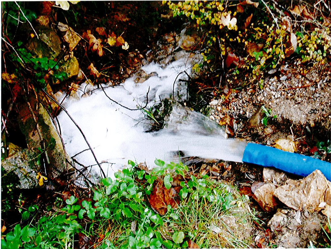
Pompage sur le forage des Douzes Q = 82 \text{ m}^3/\text{h} (novembre 2006)
