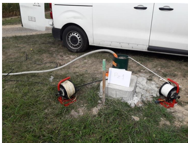
Dispositif de diagnostic au micromoulinet en place
