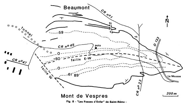
traces des affleurements de minerai (trait fort), d'après les travaux miniers et projection de quelques étages d'exploitation (tiret) avec cotes par rapport à la cote 0 du carreau (+ 38 m NGF)
