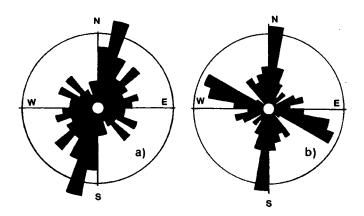
Fig. 4 - Direction de la fracturation dans la granodiorite d'Athis du territoire de la feuille Condé-sur-Noireau a) partie occidentale, principalement vallée de la Vère (81 mesures) b) partie orientale, vallée de la Rouvre (67 mesures)
