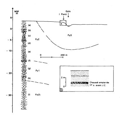
Sondage: (a) - argiles brunes, sableuses avec rares galets; (b) - graviers moyens; (c) - alluvions très argileuses et graveleuses; (d) - alluvions peu argileuses; (e) - alluvions très argileuses; (f) - alluvions peu argileuses; (i) - alluvions très argileuses; (ii) - alluvions très argileuses avec passages d'argiles blanchâtres. L'épaisseur des alluvions n'est pas connue ici; 1 km en amont, elle est à 8 m sous le lit du Golo, d'après un sondage
